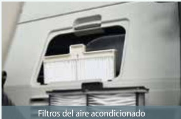
Filtros del aire acondicionado
