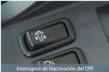
Interruptor de reactivación del DPF
